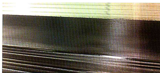
Bild 4. Bei einer Schlichtbearbeitung am Werkstoff 1.4571 konnte eine nahezu gratfreie Werkstückkante erzeugt werden.
