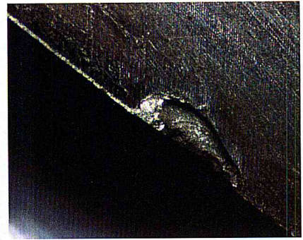
Bild 2: Bei einer Schruppoperation am Werkstoff 1.4571, die WEXO gegen zwei Wettbewerber durchführte, brach einer der konkurrierenden Fräser bereits nach etwa der Hälfte der Bearbeitung durch den zu hohen Schnittdruck. Beim zweiten kam es nach etwa 40 Minuten zu einem Schneidkantenausbruch
